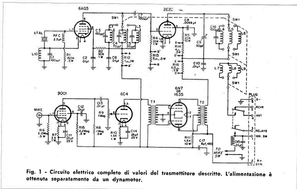
Fig. 1 - Circuito elettrico completo di valori del trasmettitore descritto. L'alimentazione è ottenuta separatamente da un dynamotor.
