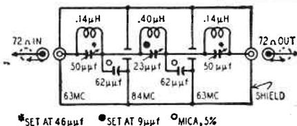
Fig. 2 - Circuito pratico del filtro per la TVI descritto in questo articolo che attenua le armoniche che cadono nei canali americani 3 e 6. Il grafico della pagina seguente servirà per altri casi.
