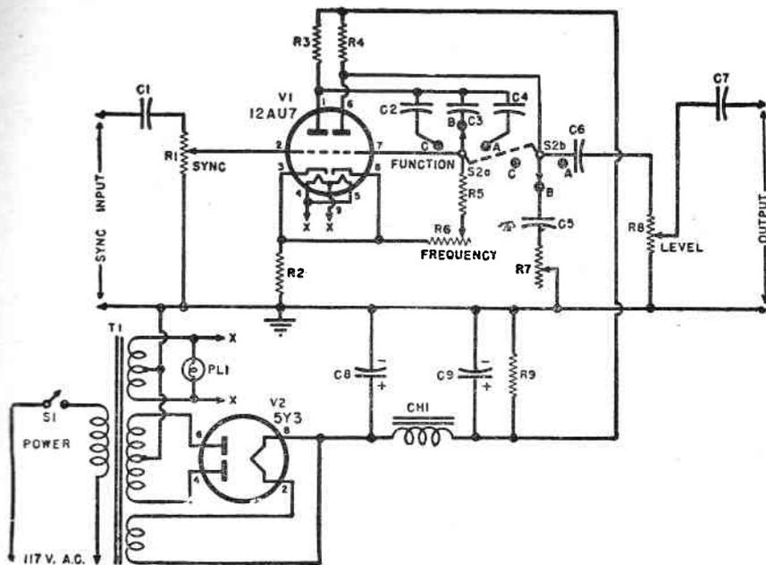
Fig. 1. - Circuito elettrico completo del semplice generatore di barre descritto in questo articolo. Sostanzialmente si tratta di un multivibratore Potter che può fornire sia un'onda quadra che un segnale trapezoidale.
