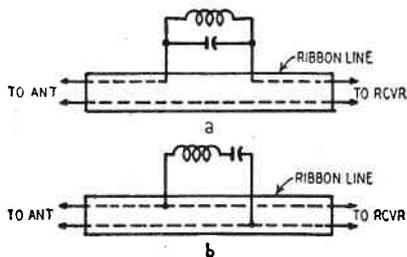
Fig. 1 - Per misurare la frequenza di risonanza di un circuito risonante in parallelo lo si collegherà in serie ad un capo della linea, mentre un circuito risonante in serie verrà collegato in derivazione.
