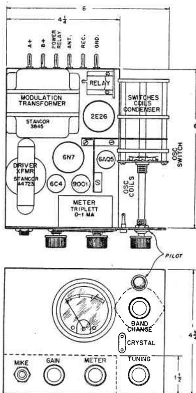
Fig. 2 - Piano di montaggio seguito dall'Autore. E' chiaramente visibile la disposizione dei vari componenti sul pannello frontale e sul telaio.
