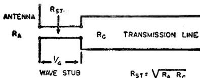
Fig. 5 - Quando si vogliono adattare impedenze diverse si ricorre agli stubs, che sono delle linee accordate ad un quarto d'onda.
