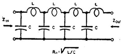
Fig. 2 - La linea di trasmissione va considerata come dotata di induttanza e di capacità e la figura ne illustra il circuito elettrico equivalente.
