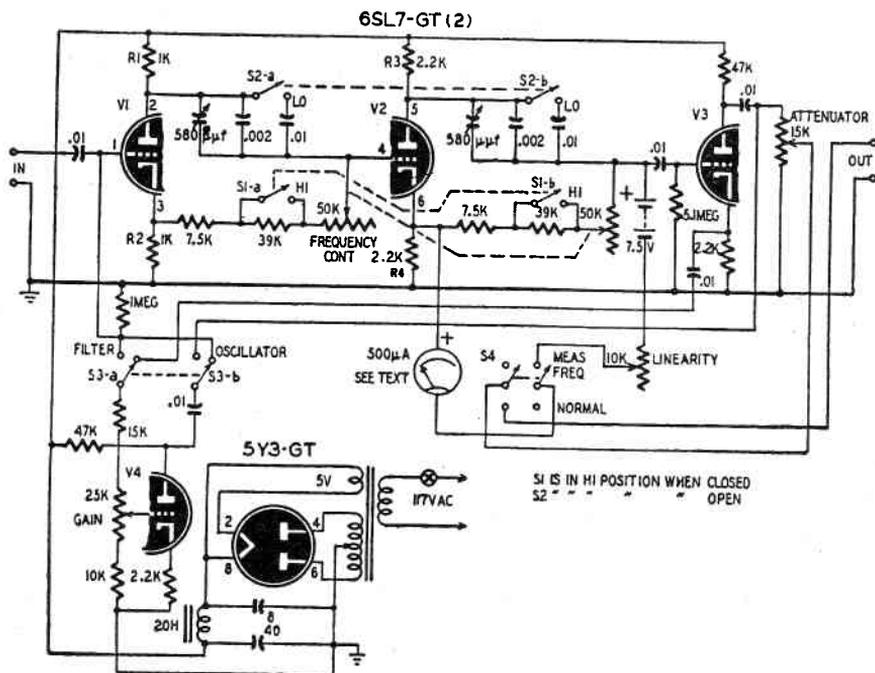
Fig. 1 - Circuito dello strumento che compie le funzioni di filtro, oscillatore BF, amplificatore selettivo e frequenzimetro.
