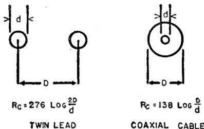
Fig. 3 - L'impedenza caratteristica di una linea di trasmissione può essere calcolata a partire dalle sue dimensioni fisiche. Nella figura sono fornite le formule per una linea bifilare e per un cavo coassiale.
