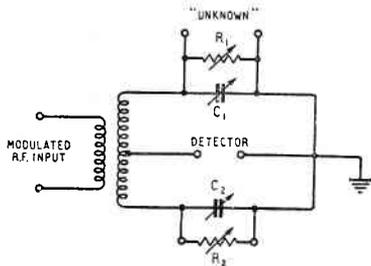
Fig. 3 - Circuito pratico del ponte che si descrive. La massima cura verrà posta nella realizzazione del trasformatore di entrata.
