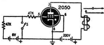
Fig. 4 - Circuito amplificatore di contatto che viene impiegato quando i contatti dell'interruttore sono troppo delicati per attivare direttamente il relè.
