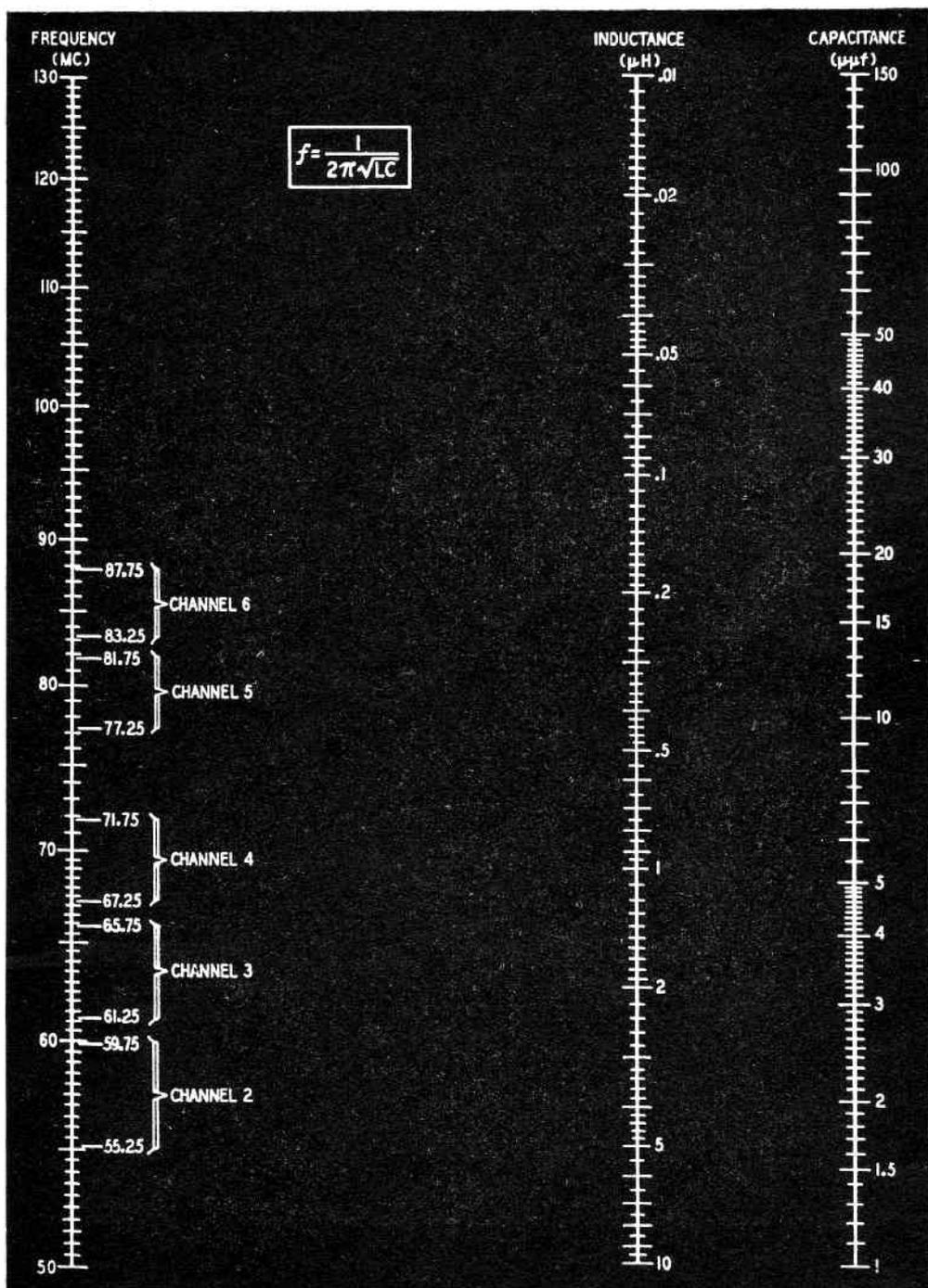
Fig. 3 - Grafico dovuto alla R.C.A. per il calcolo delle costanti per i filtri contro la TVI per frequenze fra 50 e 130 MHz.
