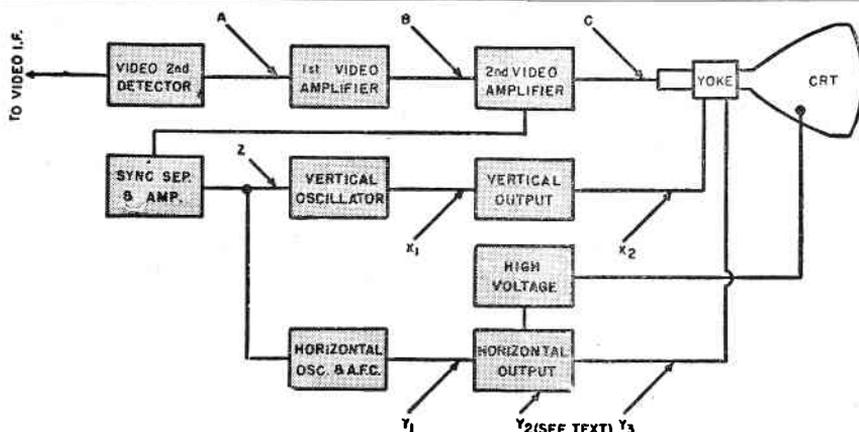
Fig. 2 - La figura illustra i vari punti del circuito di un ricevitore di televisione nei quali va iniettato il segnale prodotto dal generatore di barre per eseguire i vari controlli e misure, come è spiegato nel testo.
